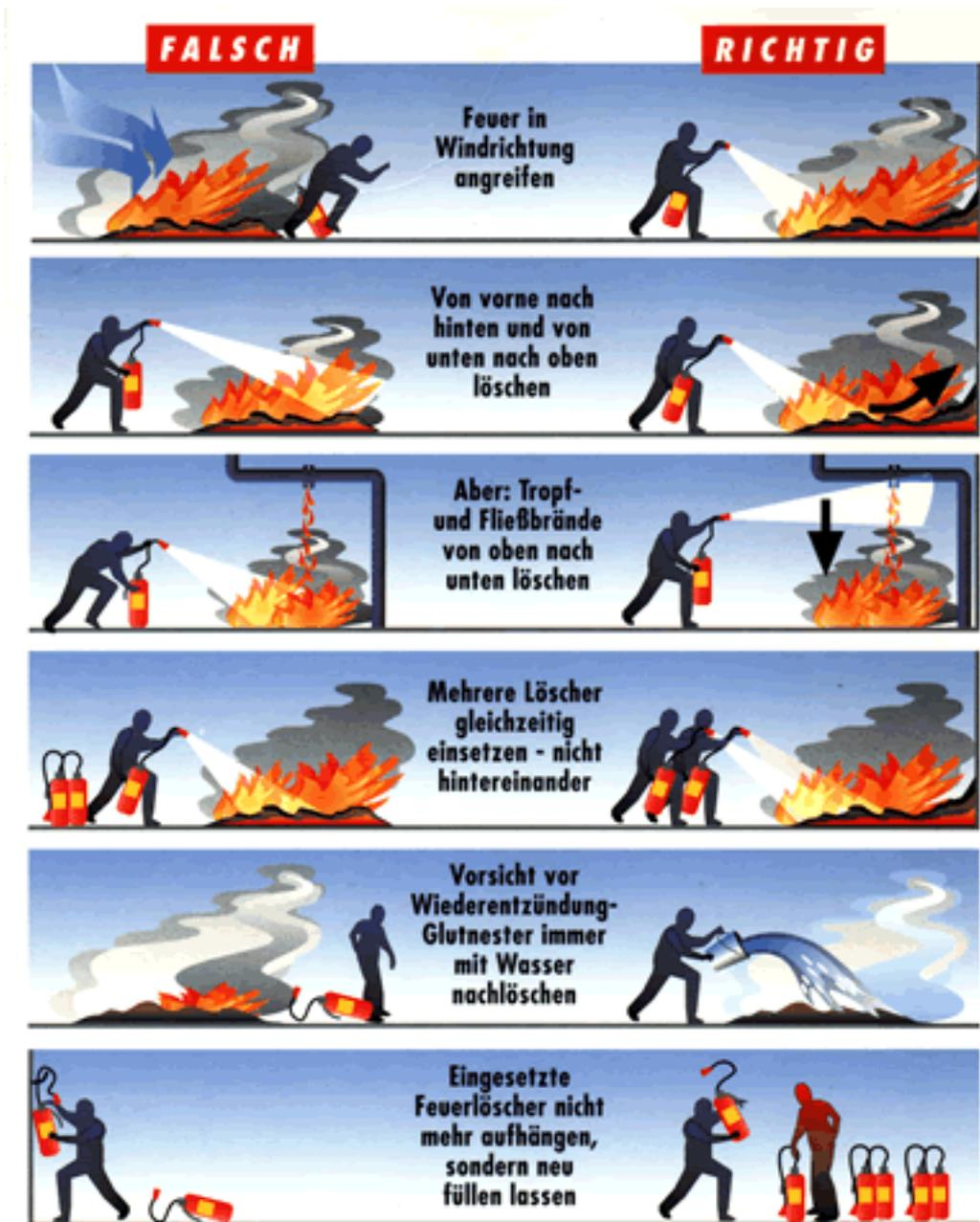
Am häufigsten wird das Löschen mit dem Feuerlöscher erfolgen. Bei der Verwendung ist die richtige Brandklasse zu beachten. Wasserlöscher sind z. B. nicht für Fettbrände und stromführende Leitungen geeignet! Daher sind im Bereich von Küchen Fettbrandlöscher oder Löschdecken vorhanden. Die Löschdecken werden über den kleinen Brandherd oder über die brennende Person gelegt und ersticken durch Sauerstoffentzug das Feuer.
